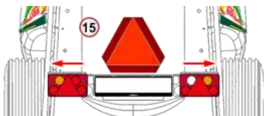
Rys. 59. Ustawienie tylnej instalacji świateł drogowych w pozycji na czas przejazdów drogowych
